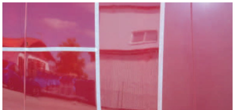
Das Modell veranschaulicht die Resultate: ganz rechts eine unbehandelte Fläche, in der Mitte aufbereiteter Lack und schließlich links eine glänzende, keramikversiegelte Oberfläche.
